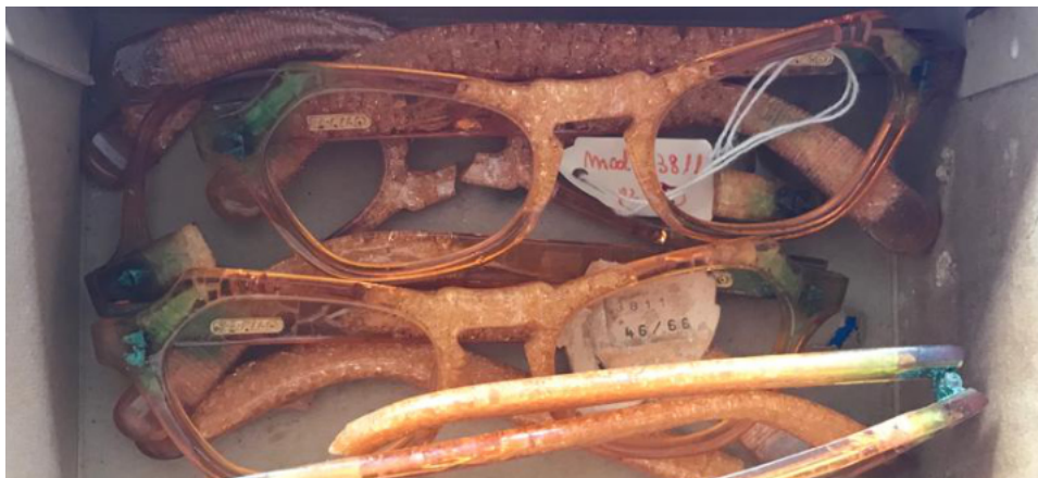
Modelli di occhiali che mostrano evidenti segni di degrado e cricature (a sinistra, occhiale SAFILO) e modelli di occhiali Lozza (collezione del Museo dell'Occhiale) che mostrano la formazione di cristalli di canfora sulla superficie (al centro e a destra)
