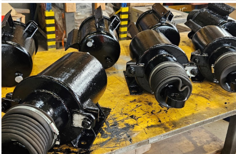
Cilindri dell'impianto frenante ricondizionati Überholte Bremszylinder
