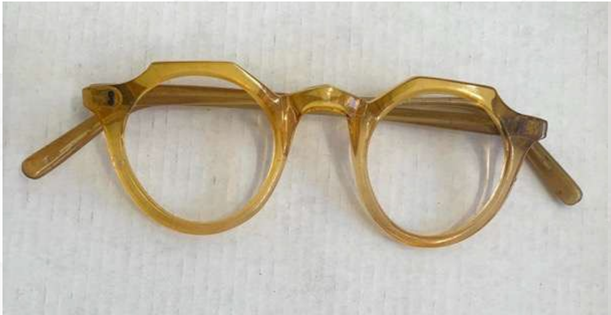
Occhiale SAFILO in acetato di cellulosa apparentemente sano. Mostra, però, deformazioni e ridimensionamenti su tutta la superficie
