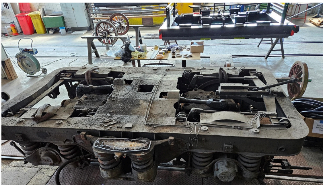
Disassemblaggio dei carrelli della locomotiva
