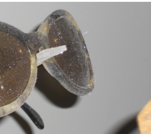
Brillenmodelle, die deutliche Abnutzungserscheinungen und Risse aufweisen (links, Brille von SAFILO) und Brillenmodelle von Lozza (Sammlung des Brillenmuseums), die die Bildung von Kampferkristallen auf der Oberfläche aufweisen (in der Mitte und rechts)
