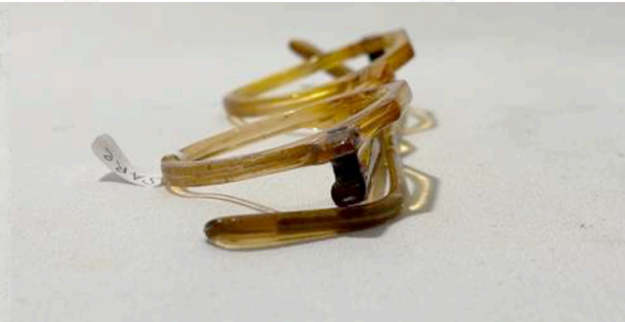
SAFILO-Brille aus Celluloseacetat, scheinbar "gesund". Sie zeigt jedoch Verformungen und Schrumpfungen auf der gesamten Oberfläche
