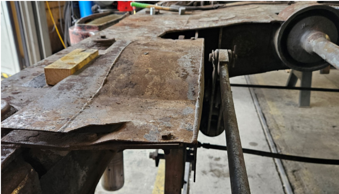
Protezioni anti scintilla in evidente stato di usura
